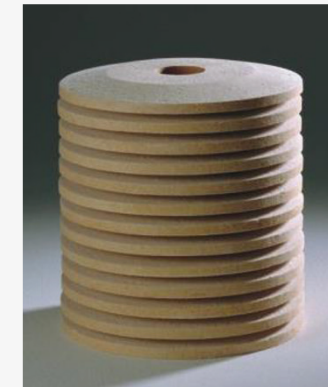
Mikrofilterpatrone TFP 1000 wärmebehandelt Schmutzaufnahme: 2.000 g Filterfeinheit 3 µm absolut inkl. Set Dichtungen
